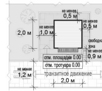
схемы места размещения нестационарного торгового объекта при размещении модуля палатки на Т-образном перекрестке тротуаров:
